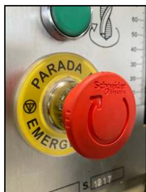
Parada de emergencia acorde a la normativa.
