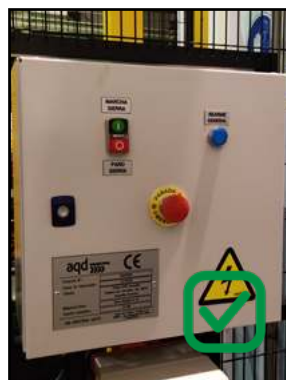
Ejemplos de armarios, botoneras e iluminación adecuados.
