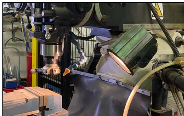
Ejemplos correctos de iluminación fija y orientable.
