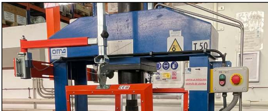
Ejemplos de pulsador, relé y parada de emergencia adecuados.
