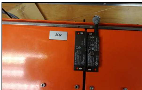
Ejemplo de aplicación de dispositivo de enclavamiento.
