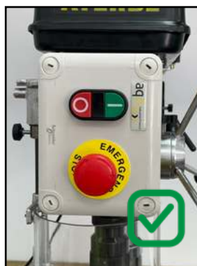
Ejemplos de armario, acometida, botoneras, parada de emergencia e iluminación adecuados.
