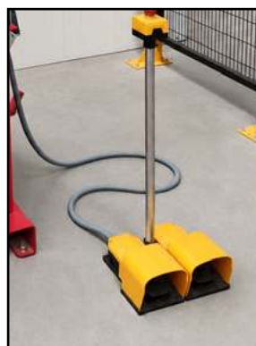
Pedal de emergencia ( enlace web ) y radar de seguridad ( enlace web ).
